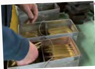
3. Waschen der Messingspitzen Washing the tips
